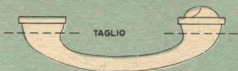
Fig. 2 - L'auricolare ed il microfono si ricavano da una cornetta telefonica.
